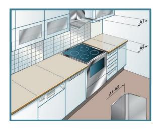
Vid limning av den sista Kitchen Wall plattan på väggen används processen som beskrivs i kapitel «Montering» (sida 2). Före plattan trycks mot bakväggen fäster man den invändiga hörnprofilen till plattans högra kant med BerryAlloc Monteringslim. Limmet appliceras både på hörnprofilens baksida och vänstra framsida.
