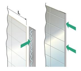
Tryck plattan med påmonterad kantprofil hårt mot väggen med hjälp av kroppstyngden. Lägg press mot hela plattans yta.
