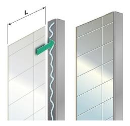
Tryck plattan med påmonterad invändig hörnprofil hårt mot väggen med hjälp av kroppstyngden. Lägg press mot hela plattans yta.
