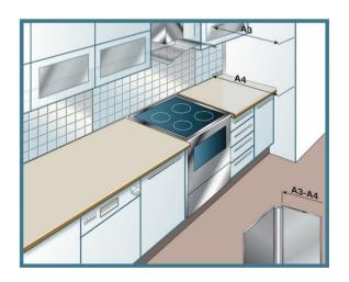
Vid limning av den sista Kitchen Wall plattan på väggen används processen som beskrivs i kapitel «Montering» på sidan 2. Före plattan trycks mot bakväggen fäster man kantprofilen till plattans högra kant med BerryAlloc Monteringslim. Limmet appliceras både på kantprofilens fram- och baksida.
