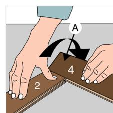
Continuate con una fila di doghe di tipo A e poi una fila di doghe tipo B, fino ad ottenere almeno 4 file. Determina il centro del muro di inizio e il centro del tuo pavimento, e allineali prima di continuare.
