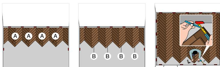
Misurate la distanza dalla parete fino all'angolo della doga, dove termina il disegno del laminato. Tenete conto dello spazio di dilatazione!
