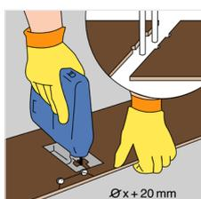
In presenza di tubazioni, misurate l'esatta posizione e marcatela sul laminato. Effettuate un foro di 20 mm più grande del diametro della tubazione, perché il laminato deve potersi dilatare/restringere liberamente attorno al tubo. Segate, partendo dai fori fino ai bordi del laminato, un angolo di 45° e inserite il laminato in posizione.
