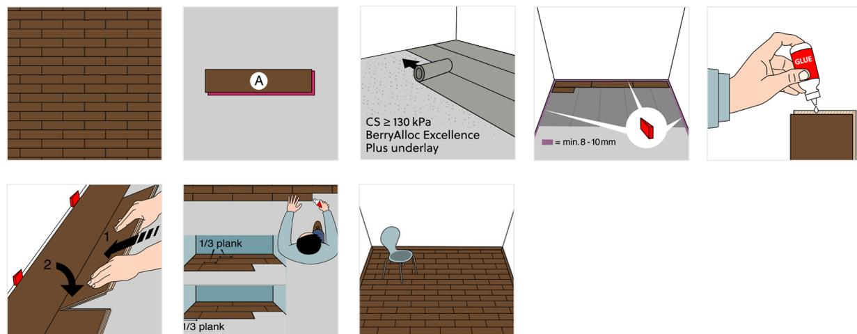
Se optate per il motivo a tolda di nave, vi servono solo doghe di tipo A. Mettete una prima doga nell'angolo della stanza, con il lato della femmina rivolto nel senso di posa. Applicate della colla sul lato corto di ogni doga, prima di posarla. Accertatevi che le giunzioni di testa siano sfalsate di 1/3 della loro lunghezza.
