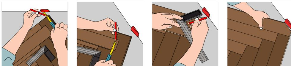
Quando si installano le ultime doghe, misurare lo spazio rimanente (X e Y). Assemblare un triangolo di doghe A e B e indicare le dimensioni di X e Y per formare una linea di taglio. Tagliare le doghe e incollarle una per una nell'apertura.
