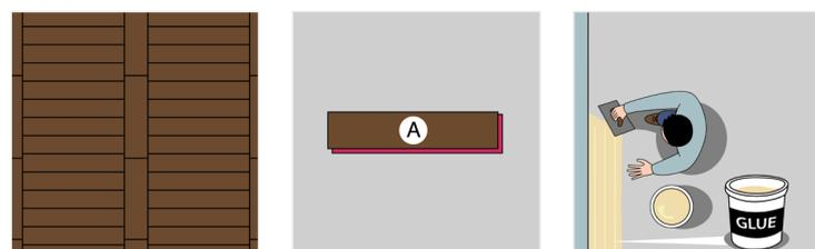
Applicate la colla con cura sul sottofondo e posate una doga nell'angolo, con la femmina rivolta verso di voi. Partite con una prima fila a ridosso della parete e proseguite con i "gradini" della scala nella direzione opposta, con la femmina rivolta verso la direzione di posa.
