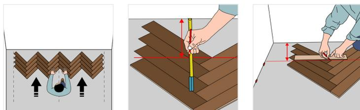
Spostate le file pronte verso la parete di partenza e tracciate una linea dritta (servirà per il taglio) attraverso l'intera fila, parallelamente alla parete. Ora avete 2 possibilità:
