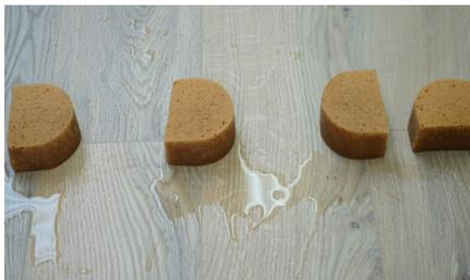
**Test 2:** Un test avec des éponges mouillées qui sont placées sur les joints d'un sol installé pour 24h.
