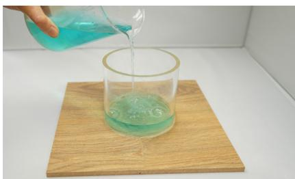
**Test 1:** Un test avec un cylindre qui est fixé sur un sol, exactement où les joints de 3 lames se connectent. On remplit le cylindre avec de l'eau teintée pendant 24h pour voir si l'eau pénètre dans les joints.
