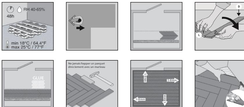
2. Pour réaliser un motif en bâton rompu, il vous faut 2 types de lames : gauche et droite. Toutes les lames doivent être marquées d'un 'G' ou d'un 'D' au dos. Assurez-vous que les rainures soient toujours dirigées dans le sens de pose. Choisissez le mur où vous souhaitez commencer l'installation. Pour cela, prenez en considération la forme de votre pièce pour déterminer et tracer son axe central. Pour les pièces en forme de L ou U, veuillez vous référer aux schémas de la fiche de pose.
